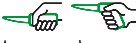
Manejo de herramienta cortante: a: Mala posición b: Buena posición
