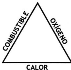
Para que una combustión pueda producirse es imprescindible la presencia de tres elementos: el combustible para quemar, el aire para dotar de oxígeno la llama y el calor para comenzar y continuar el proceso de combustión.
